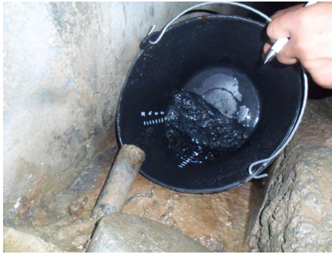
Figure VI-14 : Mesure du débit
