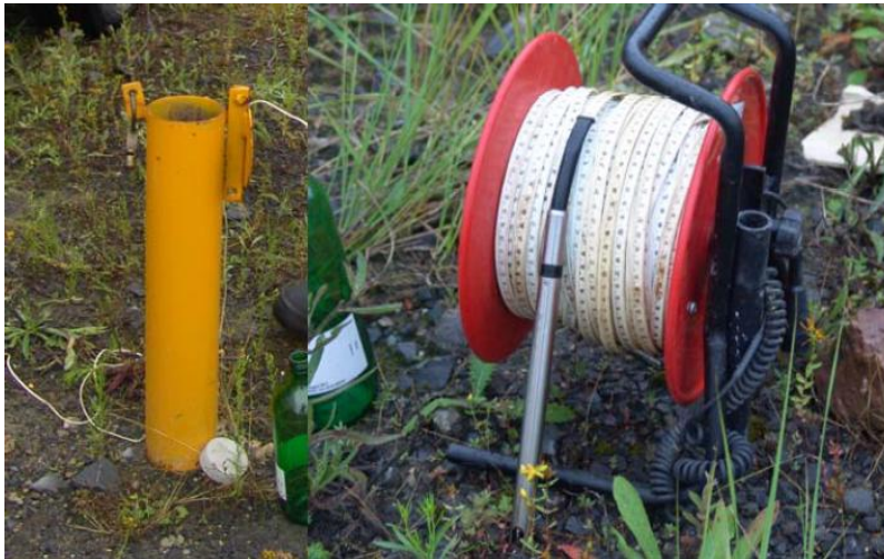
Figure IV-14: Piézomètre et sonde à interface
