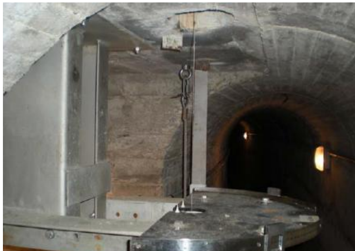
Figure IV-9 : Table de lecture d'un pendule
