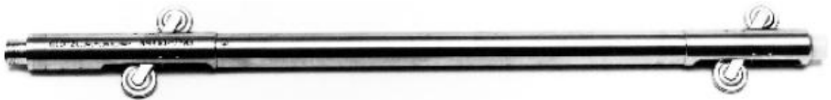
Figure IV-12 : Sonde inclinométrique avec galets de guidage
