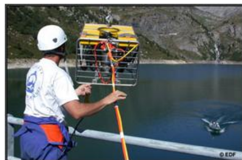
Figure III-5 : Inspection des parties immergées de la retenue par un robot subaquatique
