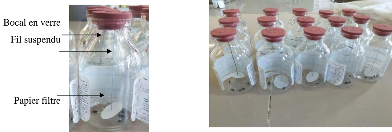
Figure 19 : Dispositif expérimental du test par inhalation à l'égard de B. rufimanus (Original, 2021)
