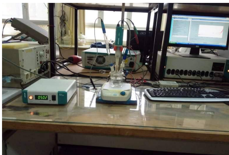
Figure II-4 : Montage expérimental de synthèse du film polypyrrole et d'électrode modifiée
