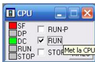
Figure IV.4: Mise en marche de la CPU.
