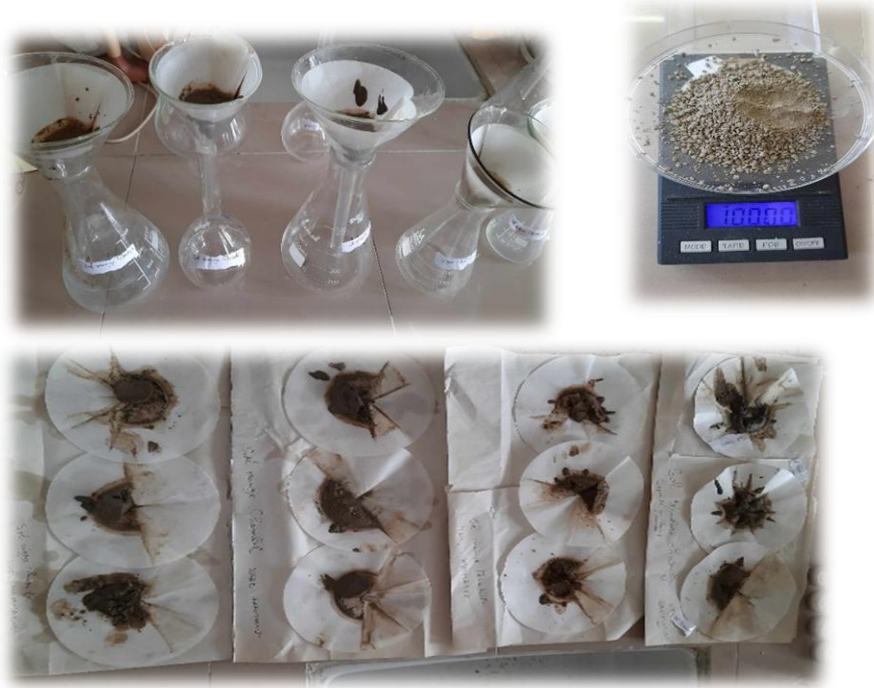
Figure 7 : Etapes de détermination du pouvoir de rétention de l'eau
