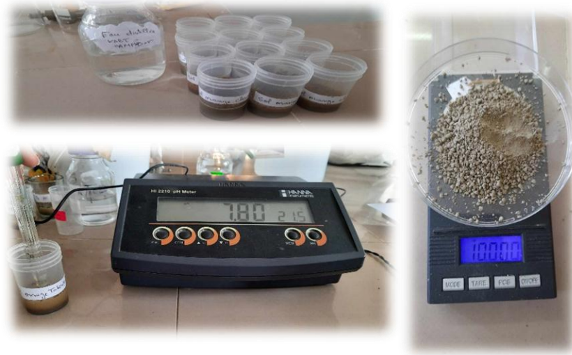
Figure 6 : Etapes de mesure du potentiel d'hydrogène (pH)
