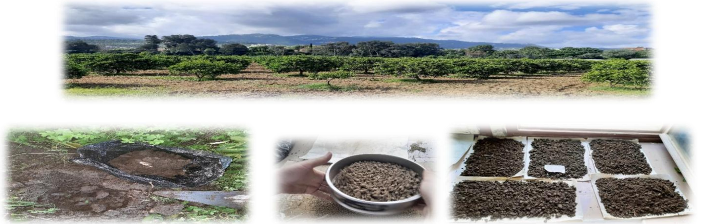
Figure 5 : Etapes de la préparation des échantillons du sol.
