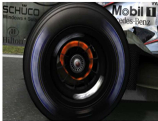
Figure I.2 : Dissipation thermique due au frottement dans un disque de formule 1
