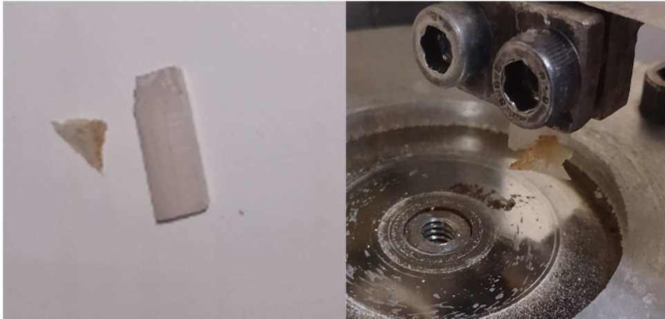
Figure III.25 : Échantillon PE rompu lors des tests d'usure à 1Mpa.m/s
