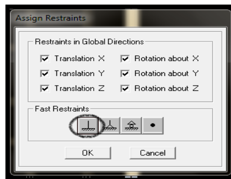
Figure 5.27 : Encastrement de la structure.
