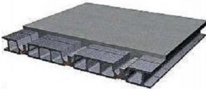
Figure I-2 : Plancher à corps creux
