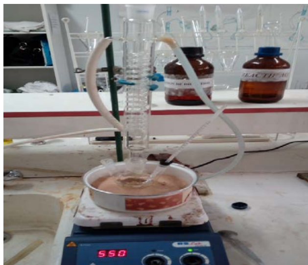
Figure 12 : Montage du chauffage à reflux pour la désacétylation de la chitine
