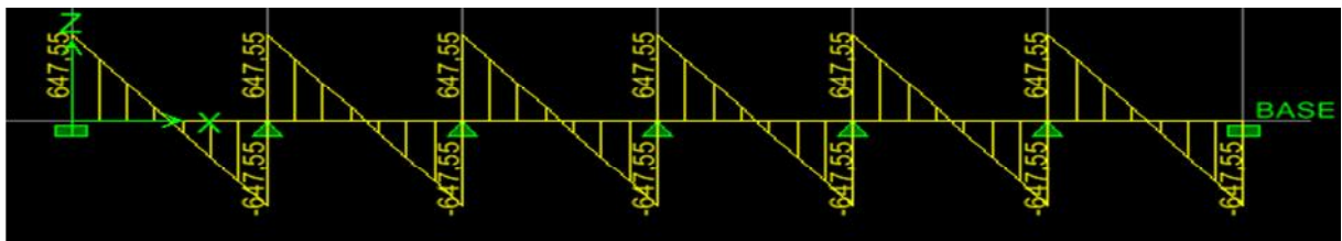
Fig VIII.11 : Diagramme des efforts tranchants (ELU).
