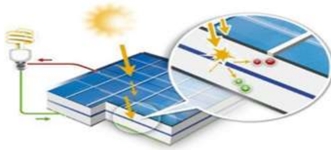
Figure (I.15) : Principe du fonctionnement d'un Générateur Photovoltaïque.
