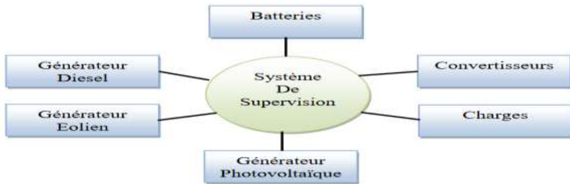
Figure (I.18) : Système de supervision.
