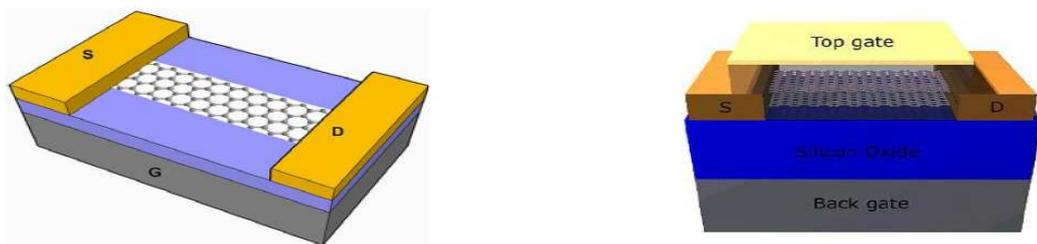
**Figure II-24 : (à gauche) structure de transistor à graphène GFET. (À droite) configuration de transistor GFET double grille.[15]**
