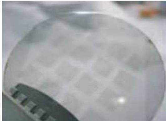
**Figure II-5 : Plaquette de SiC totalement recouverte de graphène obtenue par sublimation. Ensuite la fabrication des dispositifs est faite directement sur le substrat de SiC car celui-ci est semi conducteur à bande interdite autour de 3 eV.**
