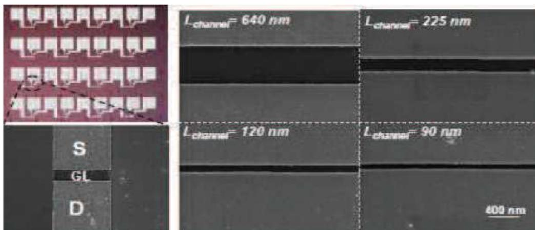
**Figure II-18 : Transistor de type pseudo MOS avec canal en graphène CVD, le graphène est obtenue ici sur feuille de cuivre puis transféré sur oxyde a l'aide de PMMA.[6]**
