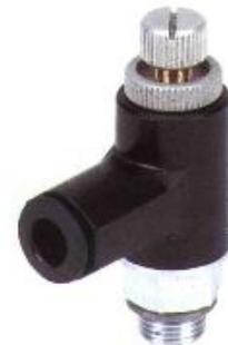
Un réducteur de débit unidirectionnel est constitué de l'association d'un clapet anti-retour et d'une restriction réglable (limiteur de débit).
