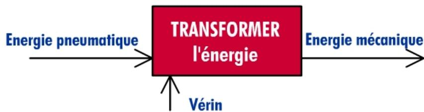
Figure IV.1 : Schéma de transformation de l'énergie
