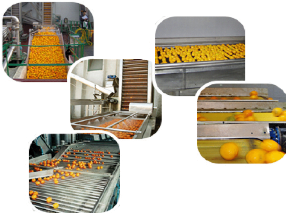
Figure 3. Les différentes étapes préliminaires de l'extraction du jus d'agrumes
