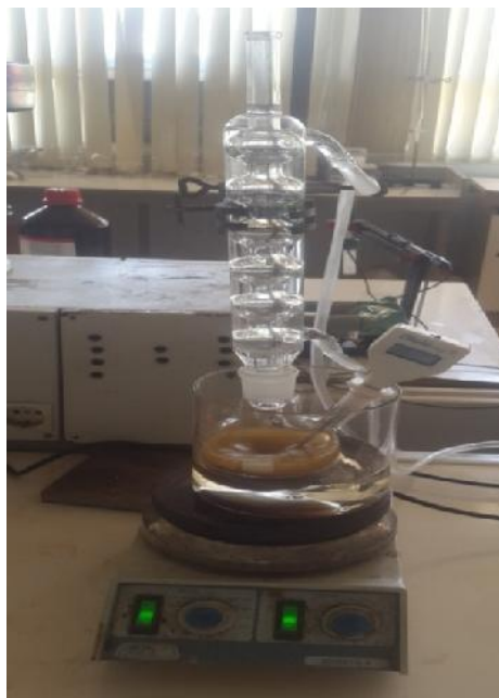
Figure 22. Montage de l'extraction à reflux total
