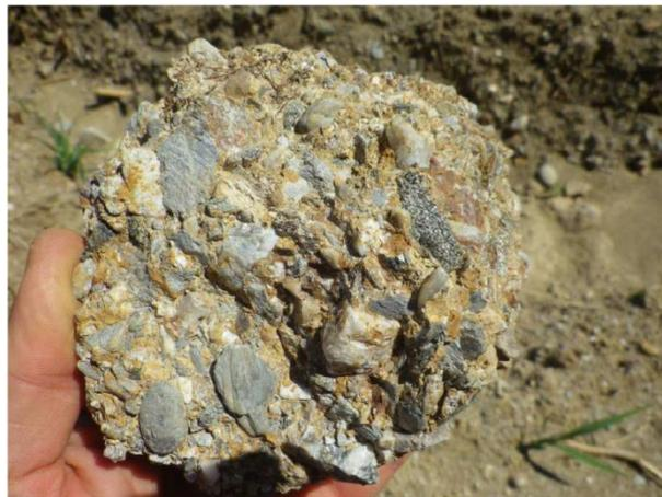
**Fig. 4.6 : Affleurement de poudingues cimentés, rive gauche (ANB, 2014A).**
