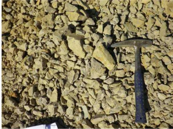
Fig. 4.9 : Affleurement de Pélite en rive gauche (ANB, 2014A).
