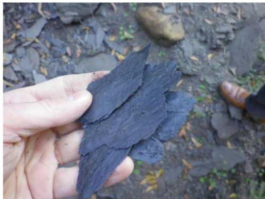
Fig. 4.10 : Affleurement de phyllades en dessous de grés burdigaliens en bas de la rive droite, à l'amont de l'axe du barrage (ANB, 2014A).
