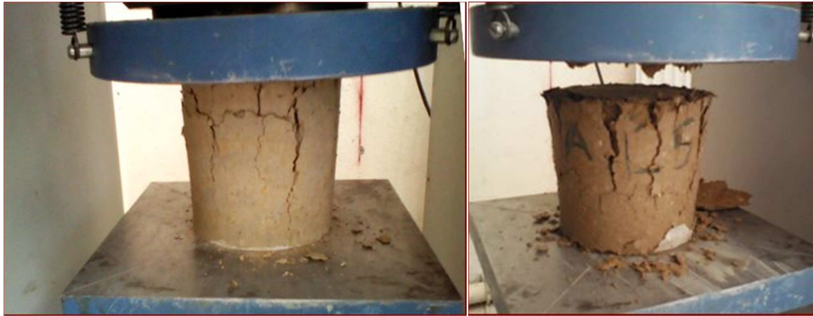
Figure VI.1 : Eprouvettes d'argile stabilisée soumise à la compression simple
