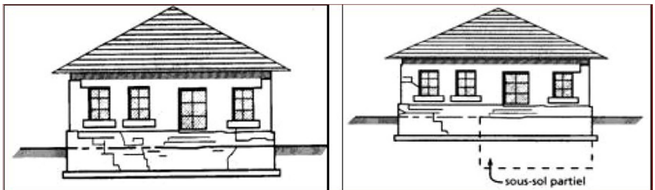
Figure III.6: Désordres concernant le gros-œuvre ; a) Désordres à l'ensemble du soubassement et de l'ossature ; b) Désordres partiels dus à l'existence d'un sous-sol partiel (Source : Ministère de l'Environnement d'après CEBTP 1991)
