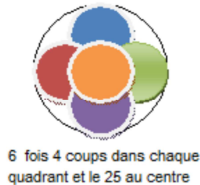
Figure IV.7 : Compactage des couches
