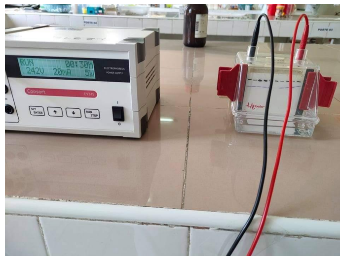
Photographie d'une unité d'électrophorèse (HOEFFER SE260).
