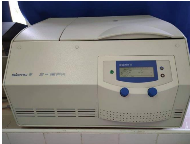
Photographie d'une centrifugeuse réfrigérée, max 28000g (SIGMA)
