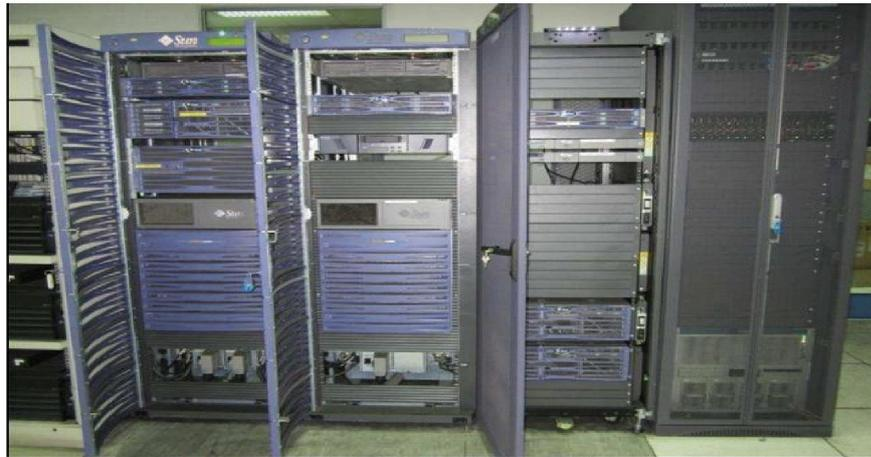
Figure 1.6 : Le contrôleur de la station de base
