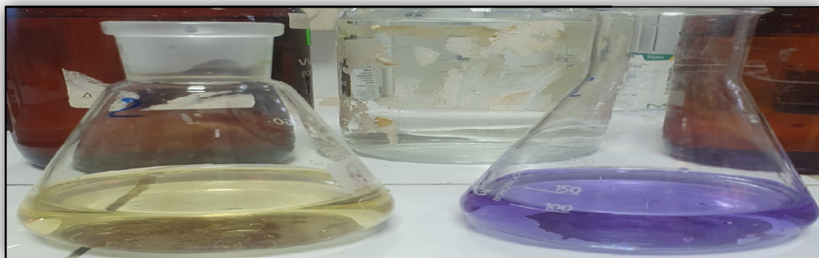
Figure 15 : dosage de titre alcalimétrique complet (TAC).
