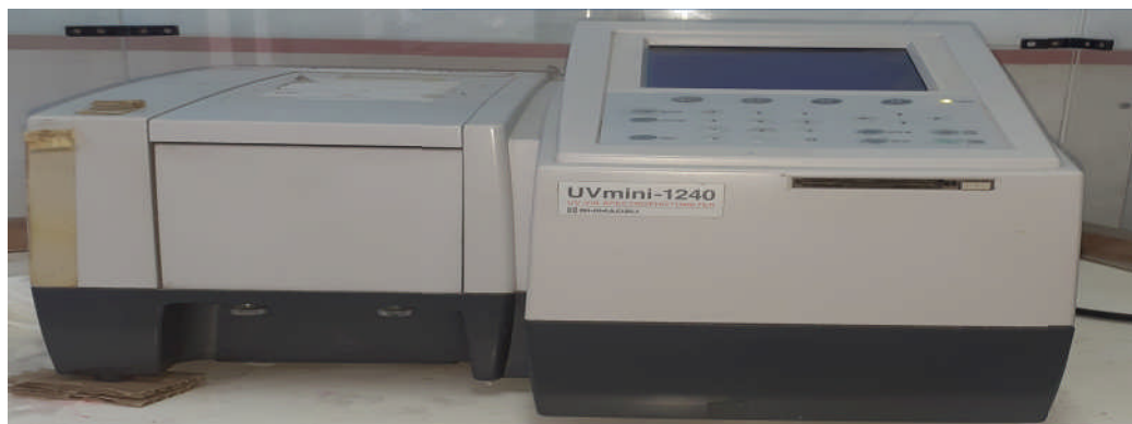
Figure 13 : spectrophotomètre de type UV mini-1240.
