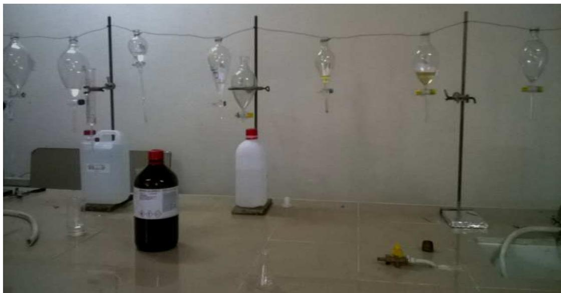
**Figure III.4.** Les ampoules utilisées pour la décantation du distillat (photo originale, 2016)
