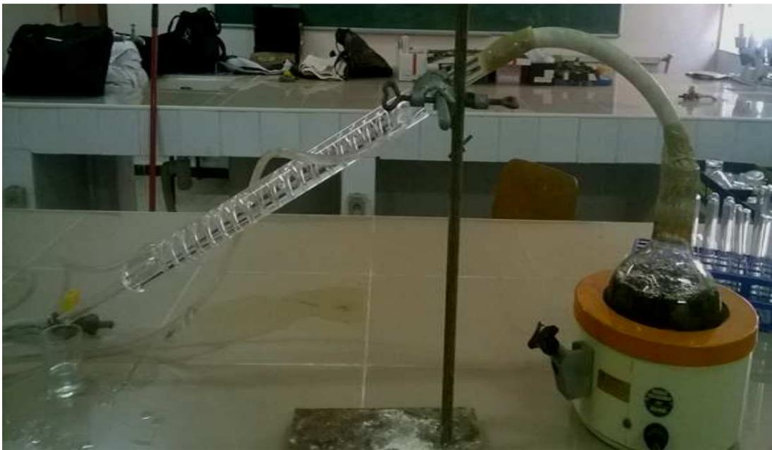
**Figure III.3.** Dispositif de l'hydro distillation (photo originelle, 2016)
