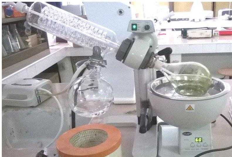
**Figure 5 : Rotavapeur utilisé**
