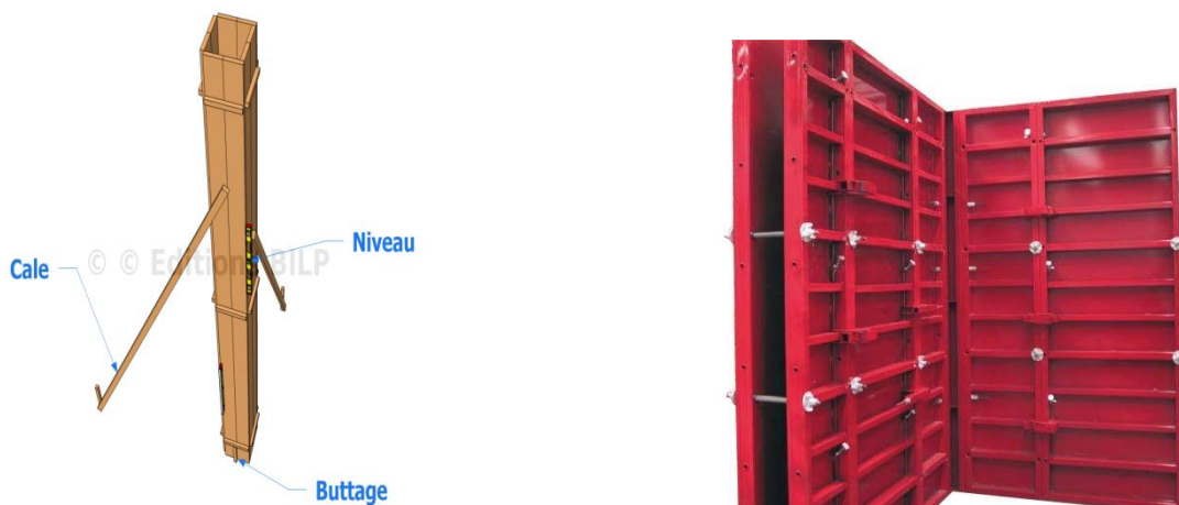
Figure I.7 : Coffrage en bois et en métallique.
