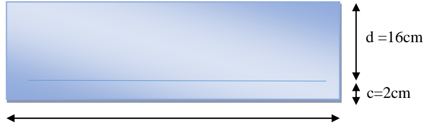
Figure 4 : une section rectangulaire d'une bande de 1m
