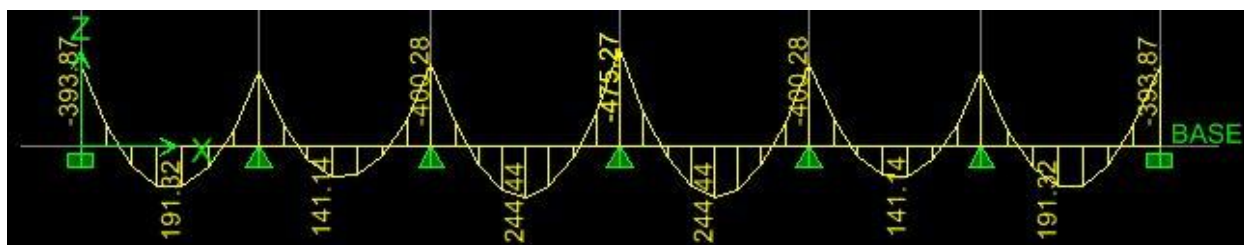
Figure. X.4. Moment fléchissant dans les nervures (ELS)
