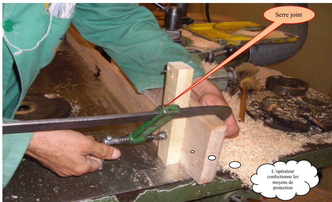
Utilisation d'un serre joint pour fixer la butée
