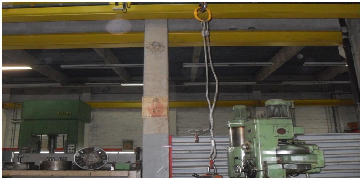
Utilisation du palan pour une procédure inhabituelle (enlever le vérin de son piston)
