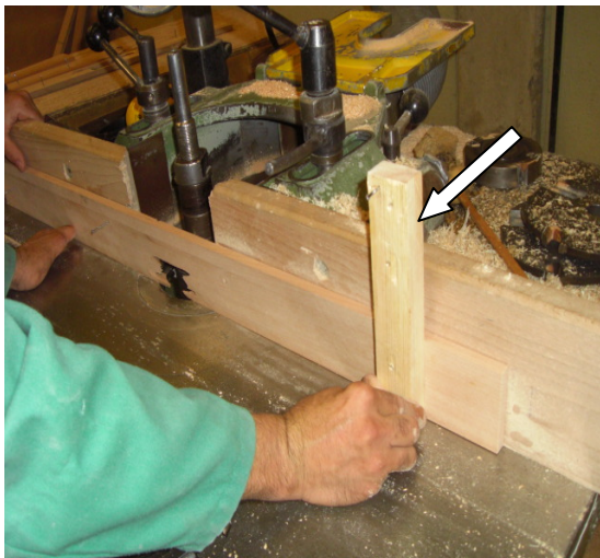
L'opérateur place la butée d'attaque selon le pointage fixé
