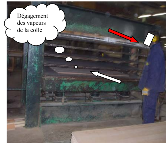
les plaques dont des faces sont recouvertes de colle sont chauffées puis plaquées, par la plaqueuse alors que l'opérateur ne porte pas de masque respiratoire adapté
