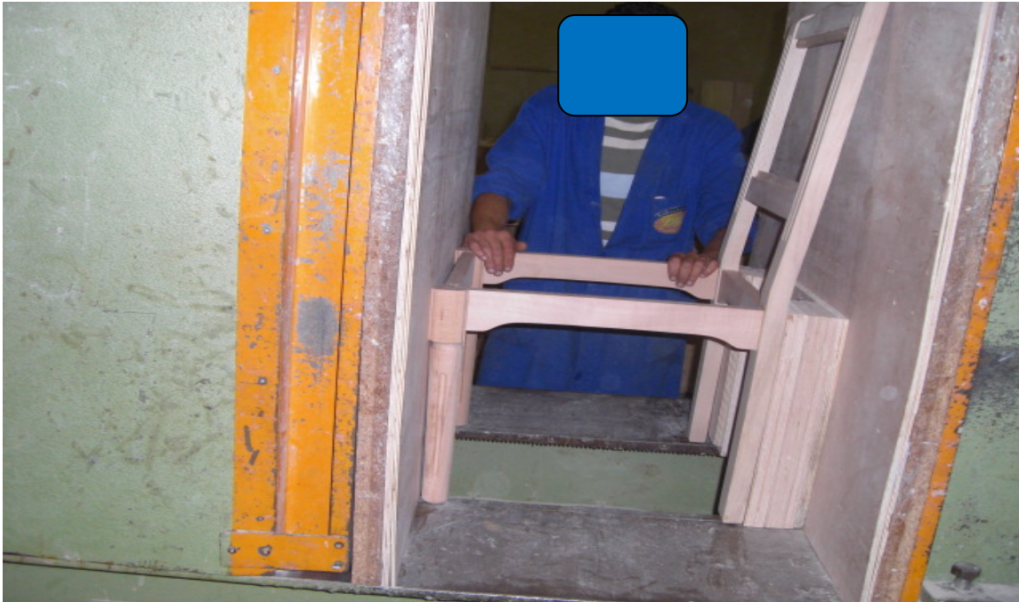
Placement d'une chaise à coller dans une presse hydraulique à panneaux
