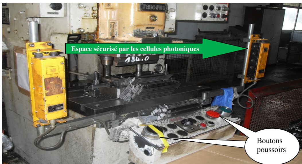
Poinçonneuse semi-automatique à double boutons poussoirs et cellules photoniques de sécurité
