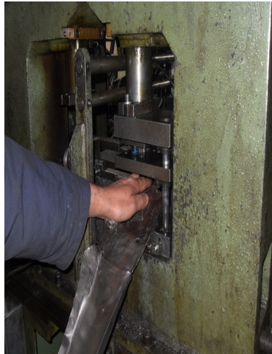
La main de l'opérateur est sous le moule de la façonneuse pour débloquer l'aillette
