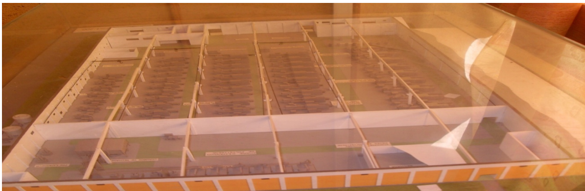
Les machines sont placées parallèlement et selon la pièce à fabriquer
