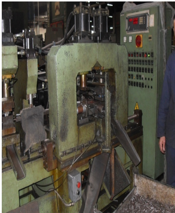
Le tableau de commande de la façonneuse est situé à un mètre du moule
