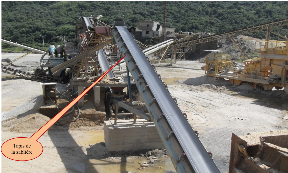
Tapis de la sablière Stita en panne par blocage d'un roulement
