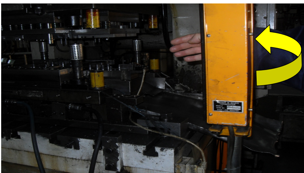
L'Espace mort non sécurisé par les cellules photoniques de sécurité
