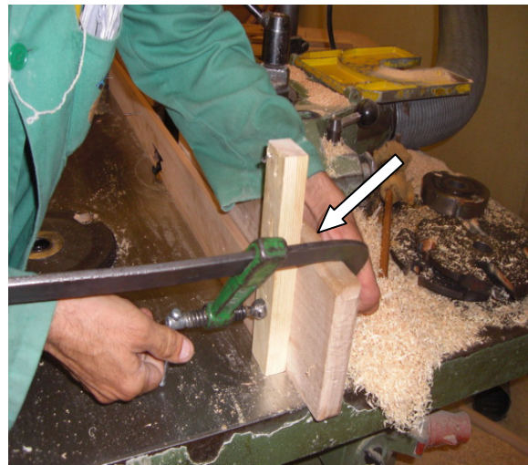
L'opérateur fixe la butée par des serres joints
