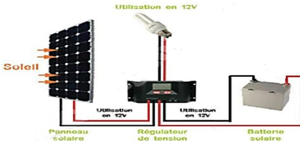
Figure (I.1) : schéma d'une Structure système photovoltaïque
