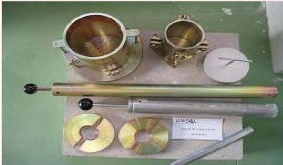
Figure IV.6.4- Matériel utilisé dans l'essai Proctor.
