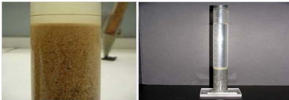
Figure IV.6.2'- Cylindre équivalent de sable avec l'échantillon GLOBAL
