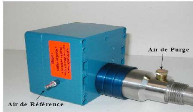
L'air de référence, par l'intermédiaire du tube intérieur est amené directement sur la pastille de zirconium.
