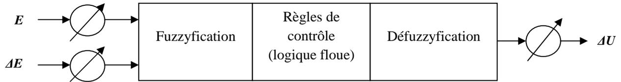
Figure IV.3 Structure interne d'un régulateur flou.
