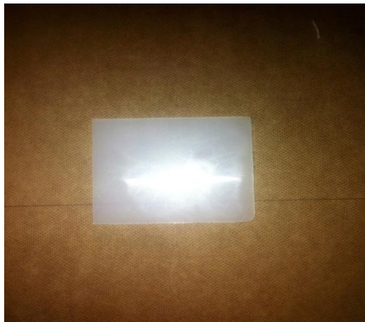
Figure III.1 : Eprouvette sous forme carrée pour les essais de claquage.
