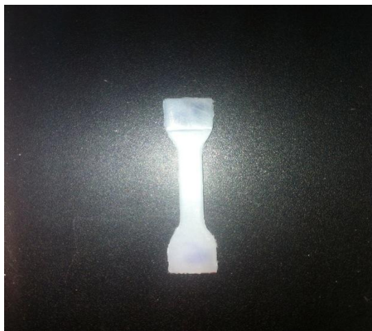
Figure III.2 : Eprouvette sous forme d'haltère pou les essais de traction.
