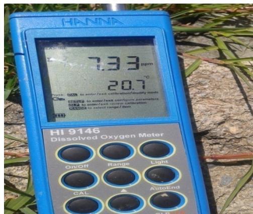
Figure 3 : Oxymètre de terrain.
