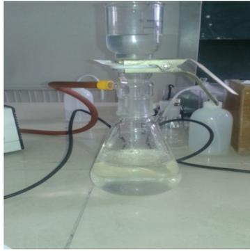
**Figure 5:** Dispositif de filtration.
