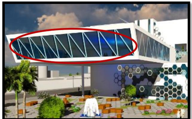
Figure 102: Contreventement au niveau de la partie en porte à faux (Restaurant) du projet.
