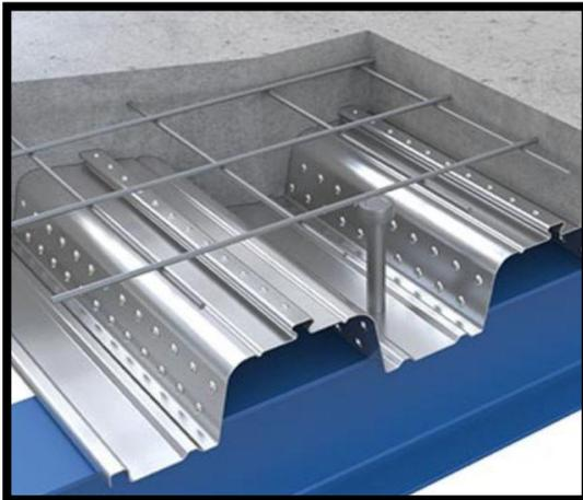
Figure 101: Constituants d'un plancher collaborant
