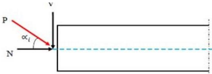
Figures VI. 6: Composante de la force de la précontrainte.
