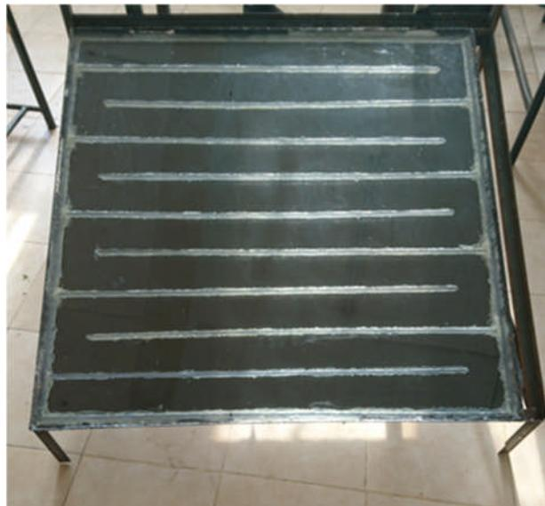
Figure. III. 1 : Vue d'ensemble du capteur solaire
