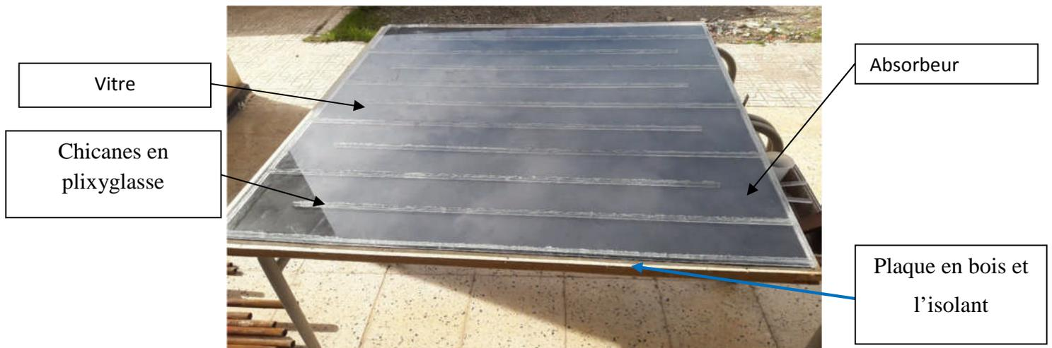
Figure III.7 : panneau solaire thermique.
