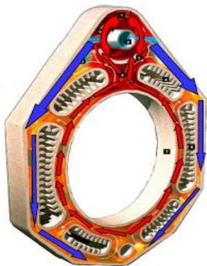
Le circuit du fluide se fait à l'intérieur de l'élément en fonte. Le fluide provenant du retour de l'installation circule sur le pourtour extérieur. Sa température est ainsi élevée avant d'arriver dans la zone la plus proche de la flamme pour éviter tout choc thermique ou point de rosée. Au contact quasiment direct de la flamme, le fluide porté à une température élevée circule naturellement par principe de thermosiphon vers le haut de l'élément pour retourner dans l'installation.
