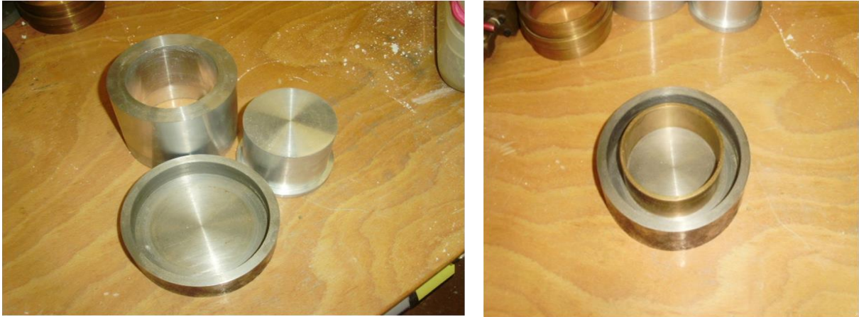
Figure 5.4 : Photos des éléments du moule de compactage.
