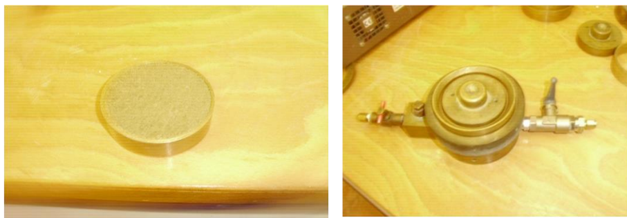
Figure 5.7: Photo de l'éprouvette après compactage : éprouvette de sol (à gauche) ; éprouvette de sol dans une cellule œdométrique (à droite).
