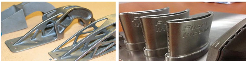
Figure I.10 : Exemples de charnières d'Airbus en un seul bloc, sans soudure, ni boulons
