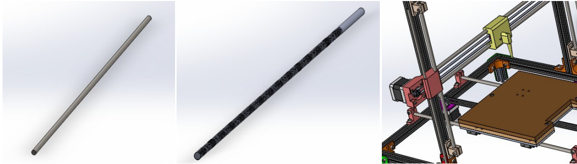
Figure II.19: Glissières et Arbre fileté
