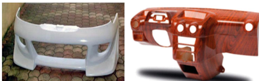
Figure I.9 : Exemple de pare-chocs et de tableau de bord imprimés en 3D
