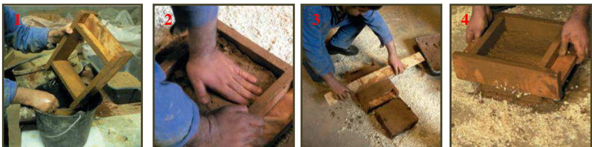
Photo II.9 : Fabrication de la brique de terre crue. (Source : Montada-Algérie)
