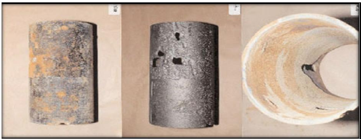
Figure VI-1: Corrosion des conduites
