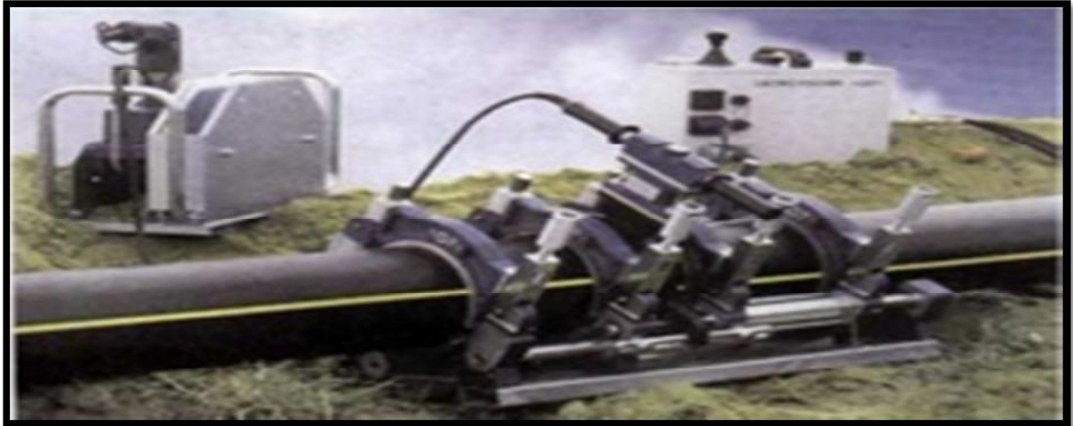
Figure VI-4: Bout à bout. « Bouteuse »
