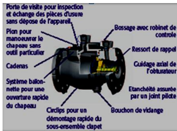
Figure VI-11: Clapet à simple battant (à brides)
