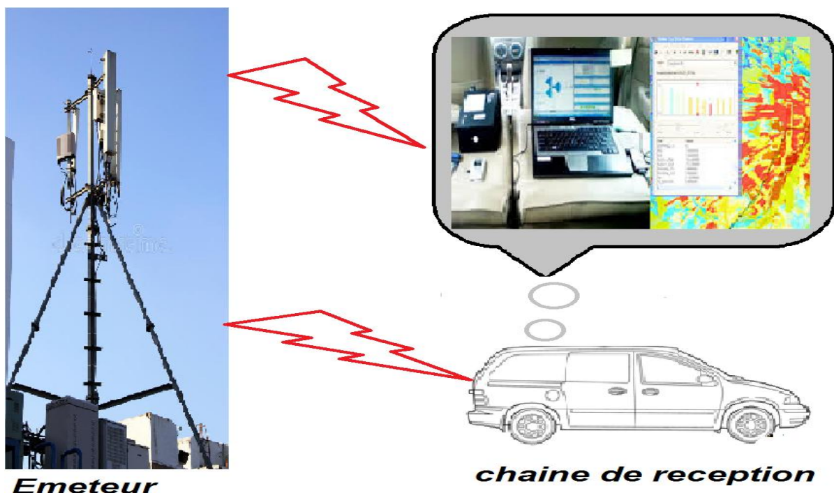
Figure III.1 : les équipements de drive test. [14]
