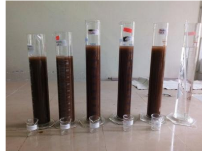
Figure 12. Sédimentation des particules de sol (Photo : Amziane et Oudachène, 2016)
