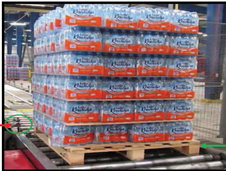
« Figure I-28 » : Arrivée d'une palette sur le convoyeur d'entrée C1.
