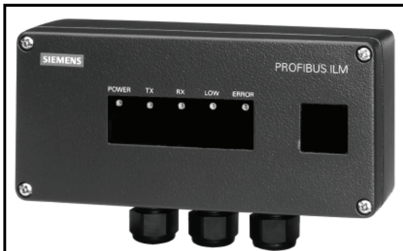
« Figure II-7 » : Module de liaison infrarouge.
