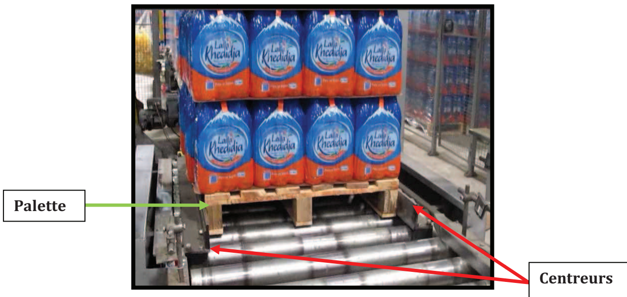
« Figure I-29 » : Dispositif de centrage palette sur le convoyeur C2 de la machine.
