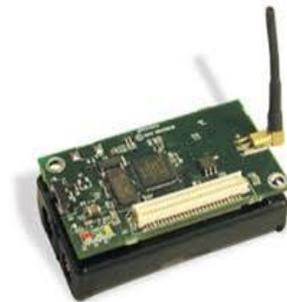
FIGURE 1.1 – Exemple d'un nœud capteur
