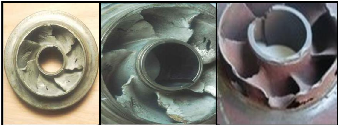
Figure VIII.7: Photos illustrant le phénomène de cavitation sur les aubes d'une pompe centrifuge
