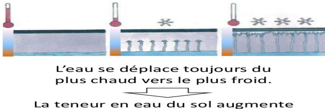
Figure.I.11.déplacement de l'eau dans les chaussées
