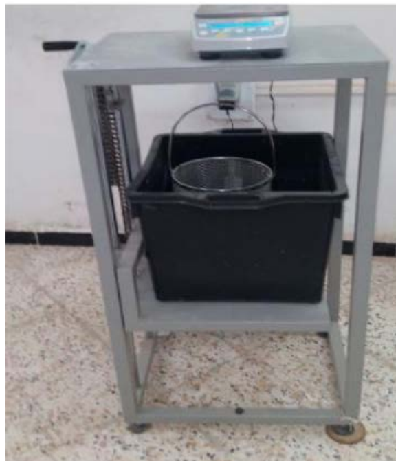
Figure III.4. Principe et matériels de la pesée hydrostatique.
