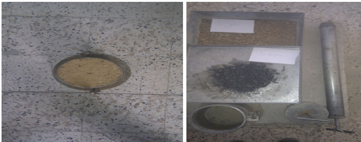
Figure V.1. Matériel de confection des éprouvettes d'essai CBR.
