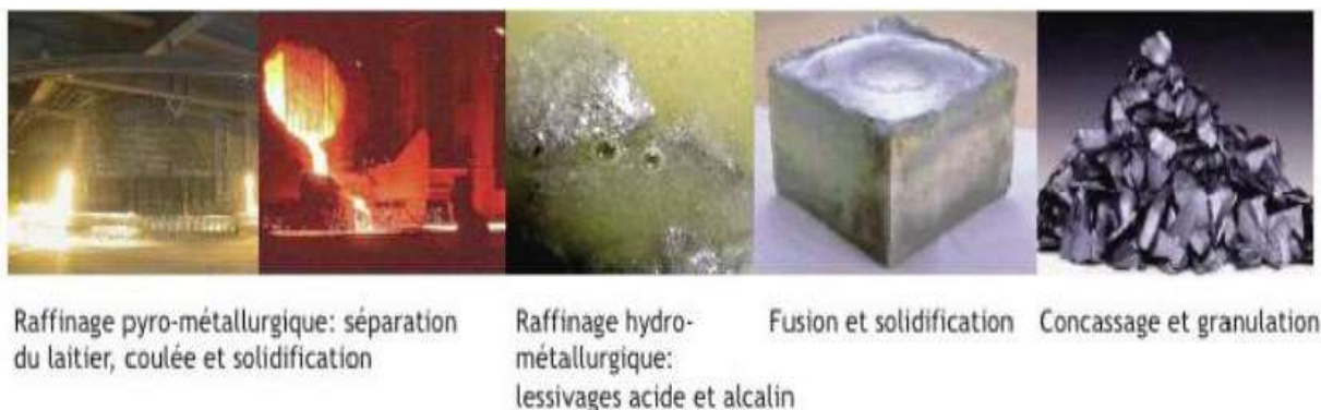
Figure I-9 : Procédé par voie métallurgique (ELKEM)
