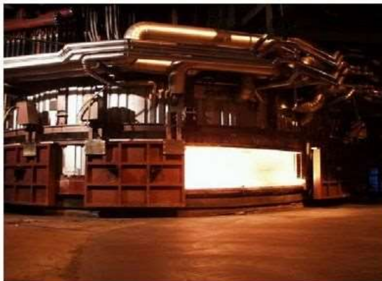
Figure I-5 : Four de production de silicium par voie carbothermique
