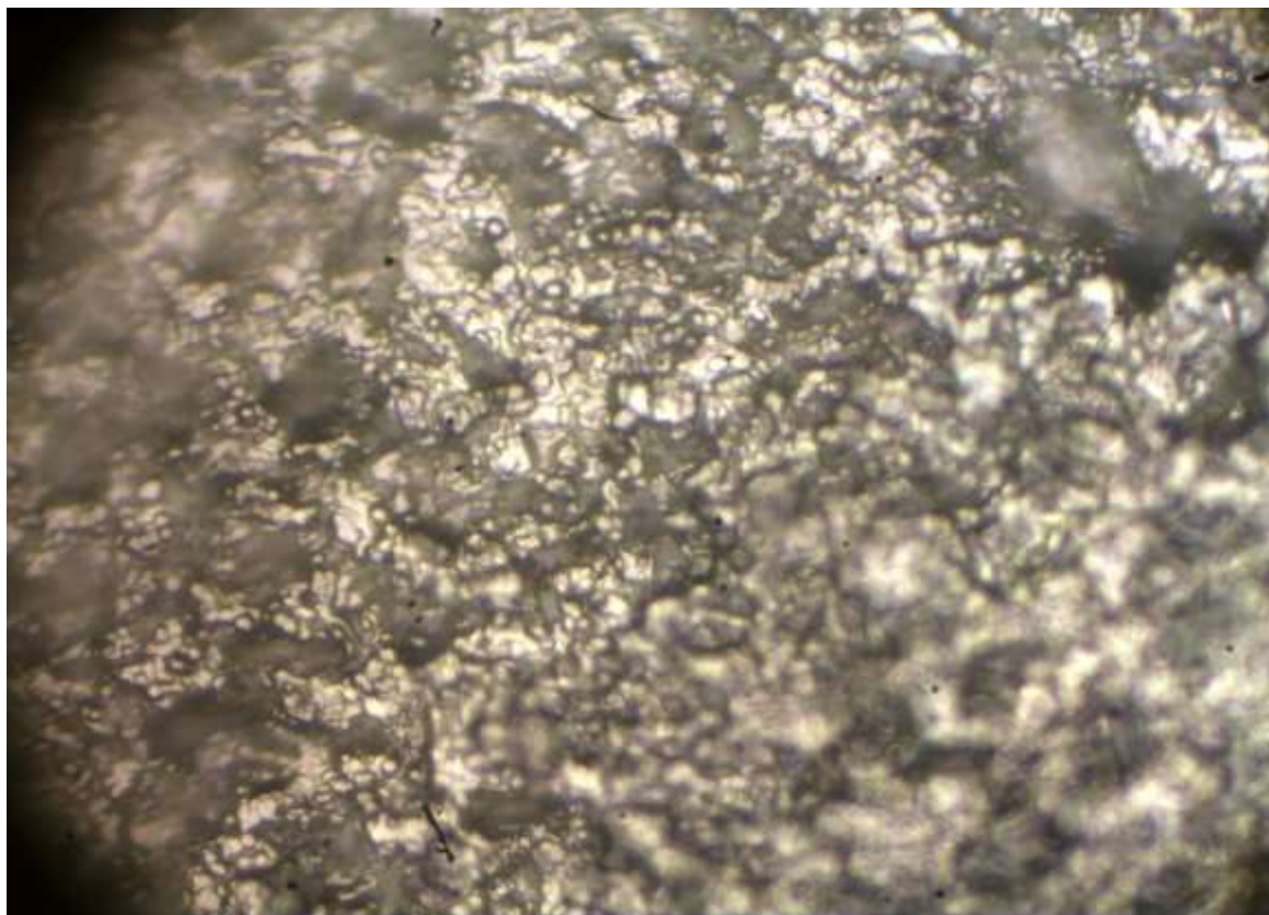
Figure IV-1 : Image en microscopie optique ( \times 400 ) de la surface du silicium mono-like.
