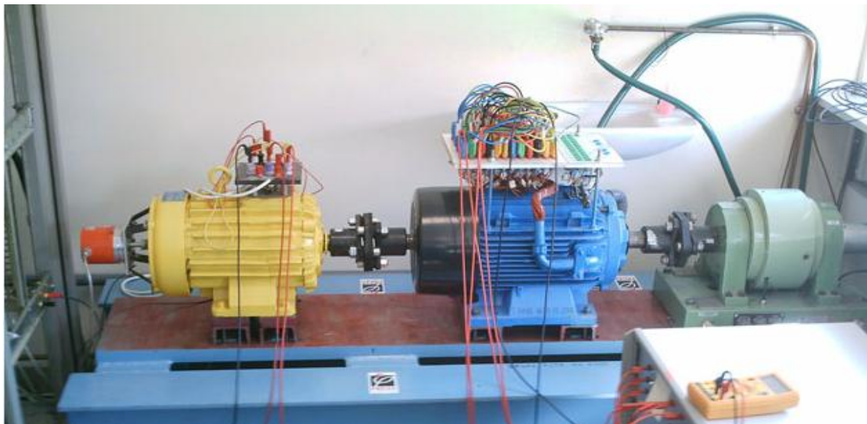
Fig. I.3 : MAS double-étoile associée à un système de commande spécial.
