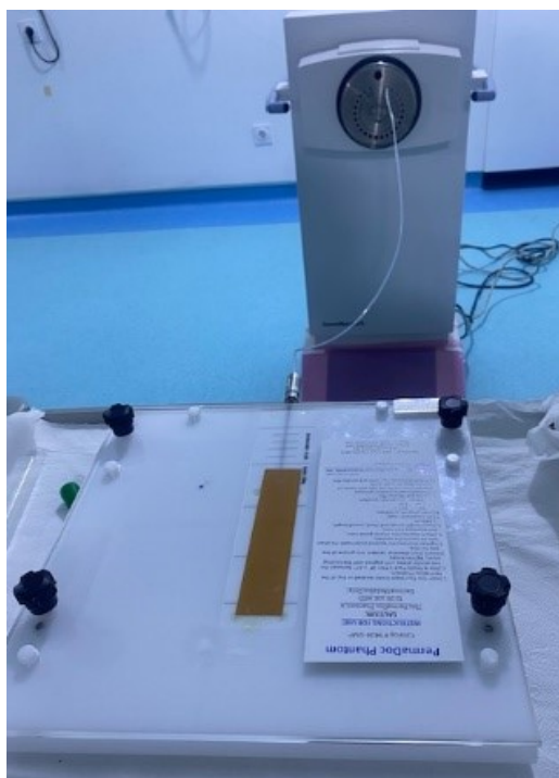
Figure 3.18 – Set-up de contrôle de qualité du positionnement de la source
