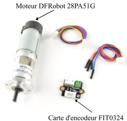
FIGURE 3.2: Moteur à courant continu et carte d'encodeur.
