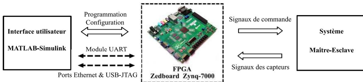
FIGURE 3.6: Système de commande en utilisant la carte FPGA Zedboard.
