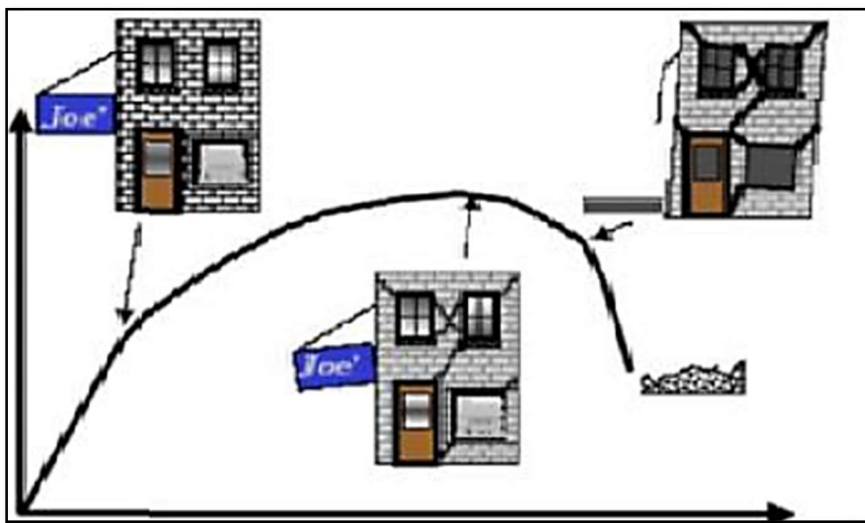
Figure I. 14 : Niveaux d'endommagement décrits par une courbe de capacité [17].
