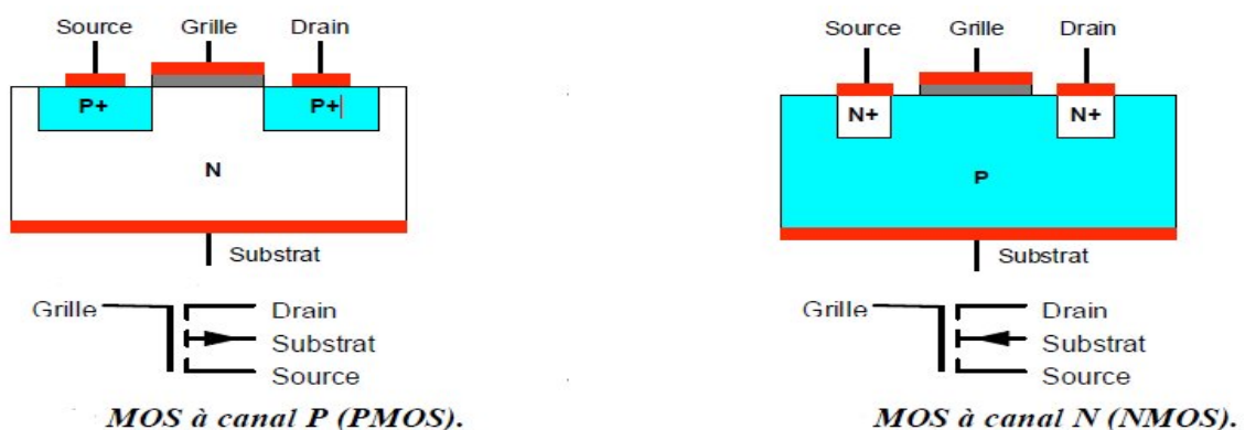
Figure. I.19. Schémas d'un transistor MOS à canal P et d'un MOS à canal N
