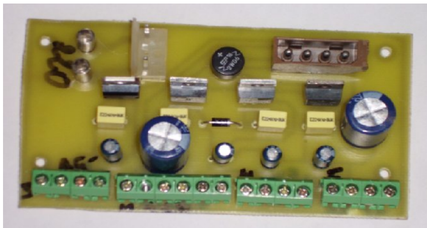
Figure 6 : Photographie de la carte d'alimentation.
