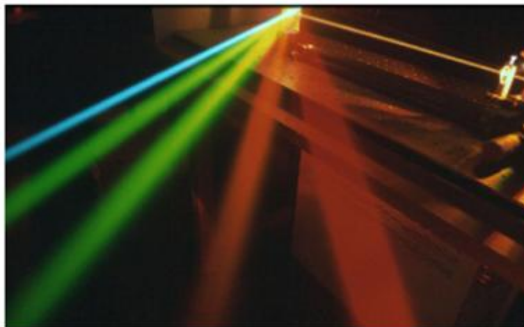
Figure I-15 : Génération de fréquences visibles dans un cristal non linéaire.[13]
