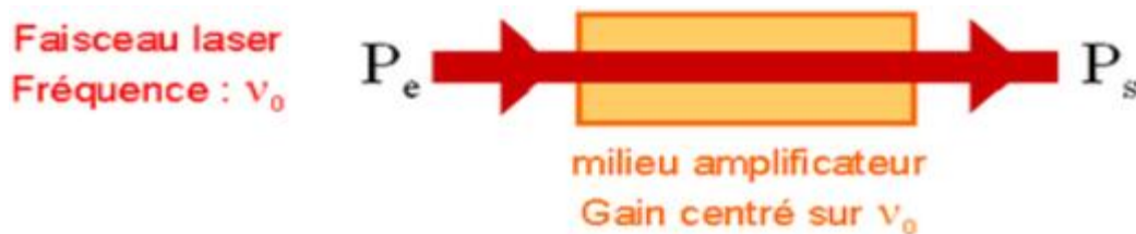
Figure I-7 : Puissance en entrée et en sortie du milieu amplificateur.[6]
